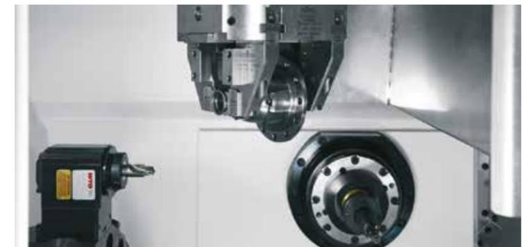
Die integrierte Frässpindel ermöglicht die Innenbearbeitung von Differentialgehäusen in einer Aufspannung
